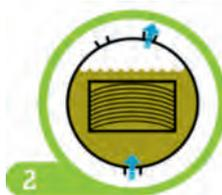
**Etape 2:** Remplissage du cylindre sous vide avec le produit de traitement du bois, un additif de couleur brune est ajouté si nécessaire.
