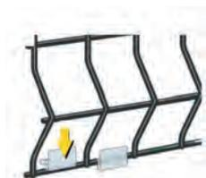
Positionner les clips sur le fil inférieur du panneau
