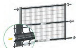
Insérer les profils dans les plis du panneau en les bloquant dans les lames d'extrémités
