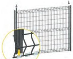
Positionner les 2 lames d'extrémités sur le panneau en les insérant dans les clips
