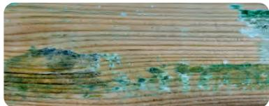
**GRISAILEMENT:** Le grisaillement est un phénomène naturel. Il découle du "délavement" du produit sous l'action des rayons UV du soleil. On peut l'éviter en recouvrant le produit, avant la pose, d'une lasure, d'une peinture à bois, d'un vernis. Le but : obtenir une filtration des UV.
