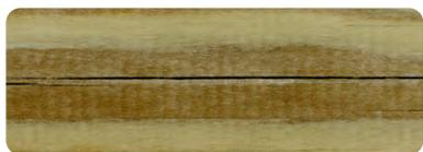
**DIFFÉRENCE DE TEINTE, DE COLORATION:** Chaque arbre est unique et chaque arbre possède des différences de formes, et de veinages. Le traitement va pénétrer différemment les couches de densités du bois, entraînant des effets de colorations différentes. Elles s'estompent rapidement à l'exposition extérieure.
