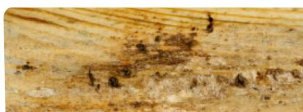
**LA RÉSINE:** Lors du traitement autoclave des bois résineux (sapin, pin sylvestre, épicéa, ...) la pression peut amener à la surface un peu de résine. Il suffit de l'enlever avec une spatule ou de l'essence de térébenthine.
