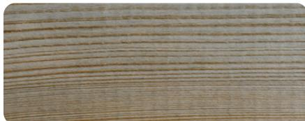
**FISSURES ET FENTES:** Le bois en séchant travaille de façon irrégulière en fonction de sa densité variable. Les éléments extérieurs (température, humidité de l'air, ensoleillement...) sont des éléments qui vont varier le séchage. Ce qui se manifeste par des fissures. Celles-ci n'affectent en aucun cas la résistance mécanique du produit, ni ses propriétés statiques.
