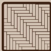
pose à bâtons rompus
